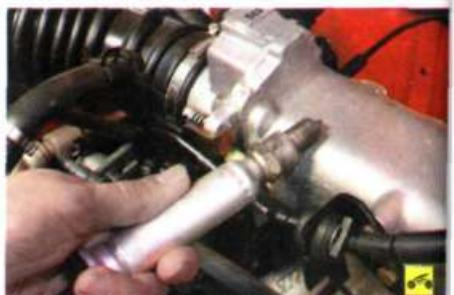
6. Возьмите запасную свечу. Любым способом зафиксируйте ее на двигателе. Подсоедините высоковольтный провод 1-го цилиндра к запасной свече. Пустите двигатель. Если перебои двигателя не усилились, замените свечу в 1-м цилиндре заведомо исправной. Наденьте высоковольтный провод и пустите двигатель. Если перебои усилились, последовательно повторяйте эту процедуру со всеми цилиндрами, чтобы выявить неисправную свечу.
