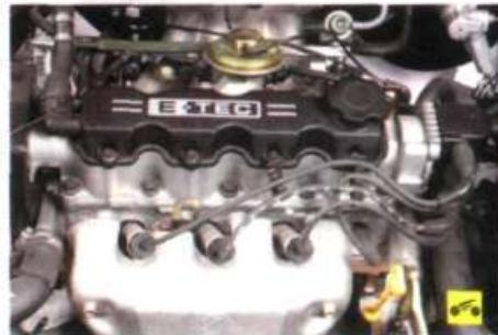
2. Если хлопки регулярны, остановите двигатель и откройте капот. Проверьте состояние проводов системы зажигания. Изоляция высоковольтных проводов не должна быть повреждена, а их наконечники не должны быть окислены. Если провода повреждены, замените неисправный провод.
