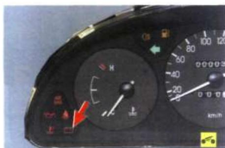
Если в комбинации приборов горит красная сигнальная лампа разряда аккумуляторной батареи, значит, ток не поступает от генератора в бортовую сеть и расходуется запас энергии аккумуляторной батареи. Эксплуатация автомобиля с горящей сигнальной лампой разряда аккумуляторной батареи недопустима, так как иногда причиной загорания лампы может быть короткое замыкание проводки, приводящее
