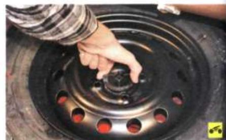
3. Отверните и снимите фиксатор запасного колеса.
