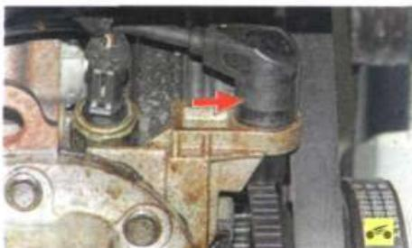
– положения коленчатого вала – полный отказ системы впрыска, двигатель не пускается;
