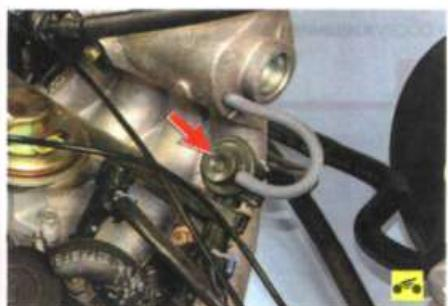
– неисправен регулятор давления топлива. Кроме того, отказ регулятора может быть вызван ослаблением посадки шланга на штуцере вакуумной камеры регулятора;
