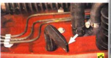
3. Через отверстие в щите передка кузова в подкапотное пространство пропущен шланг, соединенный с лотком, установленным под радиатором отопителя. Если из отверстия шланга вытекает антифриз, значит, радиатор поврежден.
