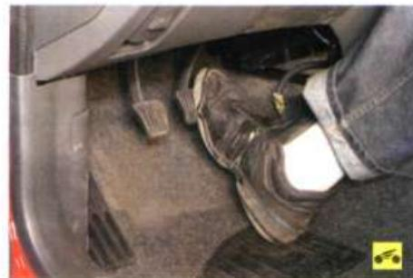
1. Причиной потери эффективности торможения может быть неудовлетворительная работа вакуумного усилителя. Для его экспресс-проверки нажмите несколько раз на педаль тормоза при неработающем двигателе, чтобы снять разрежение в усилителе, а затем, удерживая педаль, пустите двигатель. Если после пуска двигателя педаль немного опустилась, вакуумный усилитель исправен.
