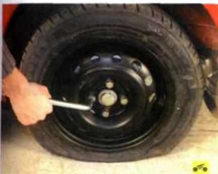
8. С помощью домкрата слегка приподнимите автомобиль, но так, чтобы колесо, требующее замены, не отрывалось от дороги. Баллонным ключом ослабьте четыре болта крепления колеса.
