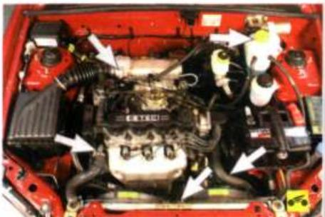
2. Откройте капот и осмотрите подкапотное пространство. Определите, откуда вырывается пар. При осмотре двигателя обратите внимание на наличие охлаждающей жидкости в расширительном бачке, на целость резиновых шлангов, радиатора, терmostата.
