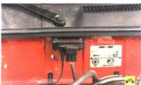
– абсолютного давления (разрежения) во впускной трубе – увеличение расхода топлива, значительное ухудшение динамики, проблемы с пуском двигателя;
