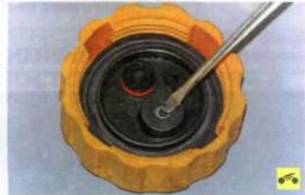
Поэтому раз в год промывайте пробку расширительного бачка проточной водой. Если появились сомнения, замените пробку. Очевидно, что если на перегретом двигателе снять пробку расширительного бачка и по времени это действие совпадет с тепловым ударом, то вскипание жидкости и образование воздушных пробок в системе охлаждения гарантированы.
