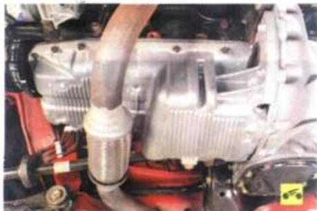
2. Загляните под переднюю часть автомобиля – не пробит ли масляный картер двигателя, нет ли там течи.
