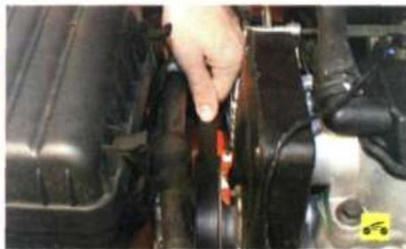
1. Проверьте, не обрван ли ремень привода генератора и насоса гидроусилителя рулевого управления. Если произошел обрыв, замените ремень и отрегулируйте его натяжение (см. «Замена ремня привода генератора и насоса гидроусилителя рулевого управления», с. 63).
