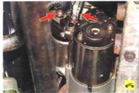
Указанные неисправности требуют квалифицированного вмешательства в автосервисе или по приезде в гараж (см. разд. 10 «Электрооборудование», с. 203). Предварительно можно лишь проверить степень разряженности аккумуляторной батареи с помощью вольтметра (например, в составе автотестера) и затяжку контактных соединений в цепи стартера.
