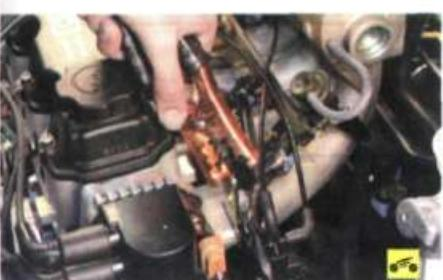
9. ...а второй зажим кабеля (с черными рукоятками) – к «массе» автомобиля с разряженной батареей в месте, расположенным по возможности на максимально удаленном от батареи расстоянии. Удобнее всего присоединять зажим к транспортной проушине двигателя.
