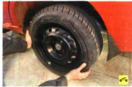
9. Поднимите домкратом автомобиль так, чтобы колесо оторвалось от дороги, после чего полностью выверните болты и снимите колесо.
