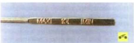
4. Выньте масляный щуп, протрите его чистой тряпкой и вставьте на место. Еще раз досмотрите щуп и проверьте уровень масла. Он должен находиться между метками «MIN» и «MAX».
