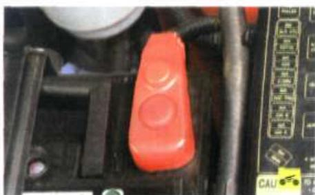
3. Если и после натяжения ремня сигнальная лампа все равно горит, проверьте провода, подсоединенные к «плюсовой»...
