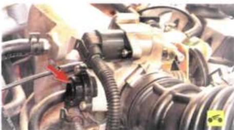
– положения дроссельной заслонки – потеря мощности, рывки и провалы при разгоне,
