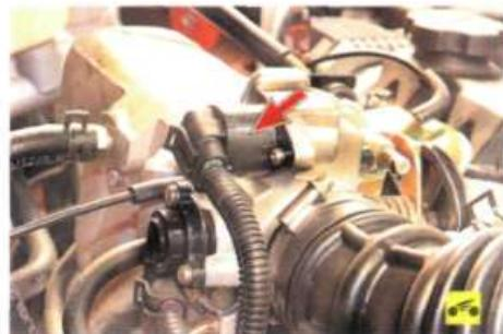
Однако необходимо отметить, что чаще всего эту неисправность вызывает отказ регулятора холостого хода или подсос постороннего воздуха через неплотные соединения шлангов, присоединенных к дроссельному узлу. Если заменой регулятора (см. «Проверка и замена регулятора холостого хода», с. 128) и подтяжкой хомутов шлангов восстановить холостой ход не удалось, обратитесь к специалистам.
