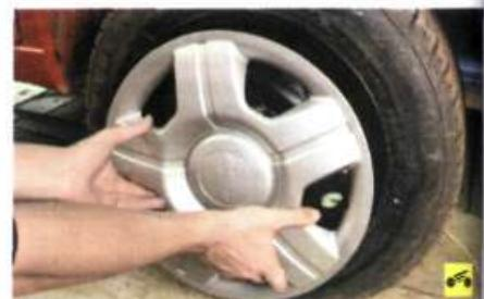
5. Снимите декоративный колпак, преодолевая усилие его фиксирующей пружины.
