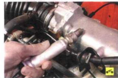
3. Если низковольтная цепь катушки зажигания исправна, проверьте наличие искры на свечах зажигания. Снимите высоковольтный провод с любой свечи зажигания. Вставьте в наконечник провода запасную свечу зажигания и прижмите ее металлической частью к «массе» автомобиля (например, к впускной трубе). Попросите помощника провернуть стартером коленчатый вал двигателя.
