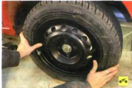
10. Установите запасное колесо на место снятого, вверните крепежные болты до упора, но не затягивайте их...
