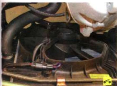
5. Очень часто причиной перегрева двигателя, система охлаждения которого оснащена электрическим вентилятором, является выход из строя вентилятора.
