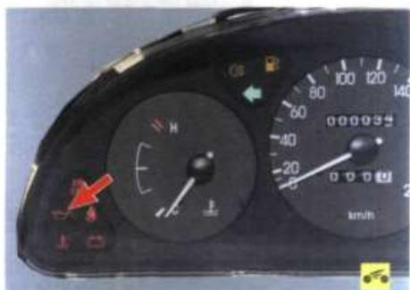
В комбинации приборов вашего автомобиля есть сигнальная лампа аварийного падения давления масла в двигателе. Для надежной работы двигателя необходимо, чтобы в системе смазки двигателя постоянно обеспечивалось достаточно высокое давление.
