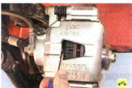
5. Проверьте подвижность поршня тормозного механизма. Для этого попробуйте
