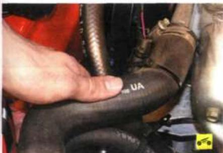
4. Двигатель может перегреться в случае выхода из строя термостата, который регулирует прохождение потока жидкости в системе охлаждения через радиатор или мимо него (для ускорения прогрева холодного двигателя). Для проверки термостата нужно на прогретом двигателе проверить на ощупь температуру верхнего шланга, соединяющего термостат с двигателем. Если верхний шланг радиатора холодный, термостат неисправен, циркуляции через радиатор нет.
