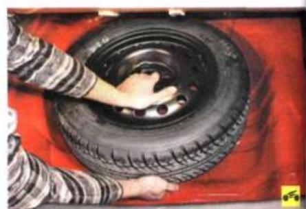
4. Выньте запасное колесо из багажника и положите его рядом с заменяемым колесом.
