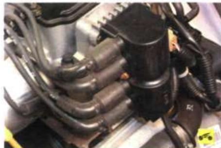
1. При выключенном зажигании проверьте целостность и посадку высоковольтных проводов
