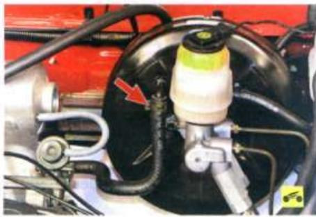
3... и с усилителем. Неисправный шланг замените или отремонтируйте. Если шланг исправен, необходимо заменить вакуумный усилитель (см. «Замена вакуумного усилителя», с. 191).
