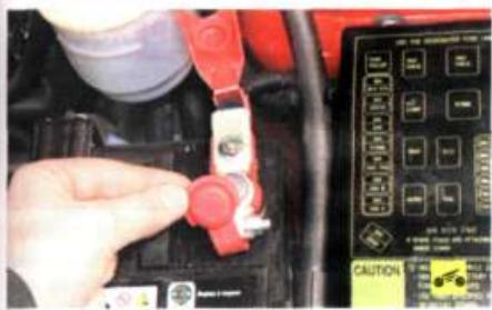
5. ...и малую защитные крышки клеммы «плюс» разряженной аккумуляторной батареи.
